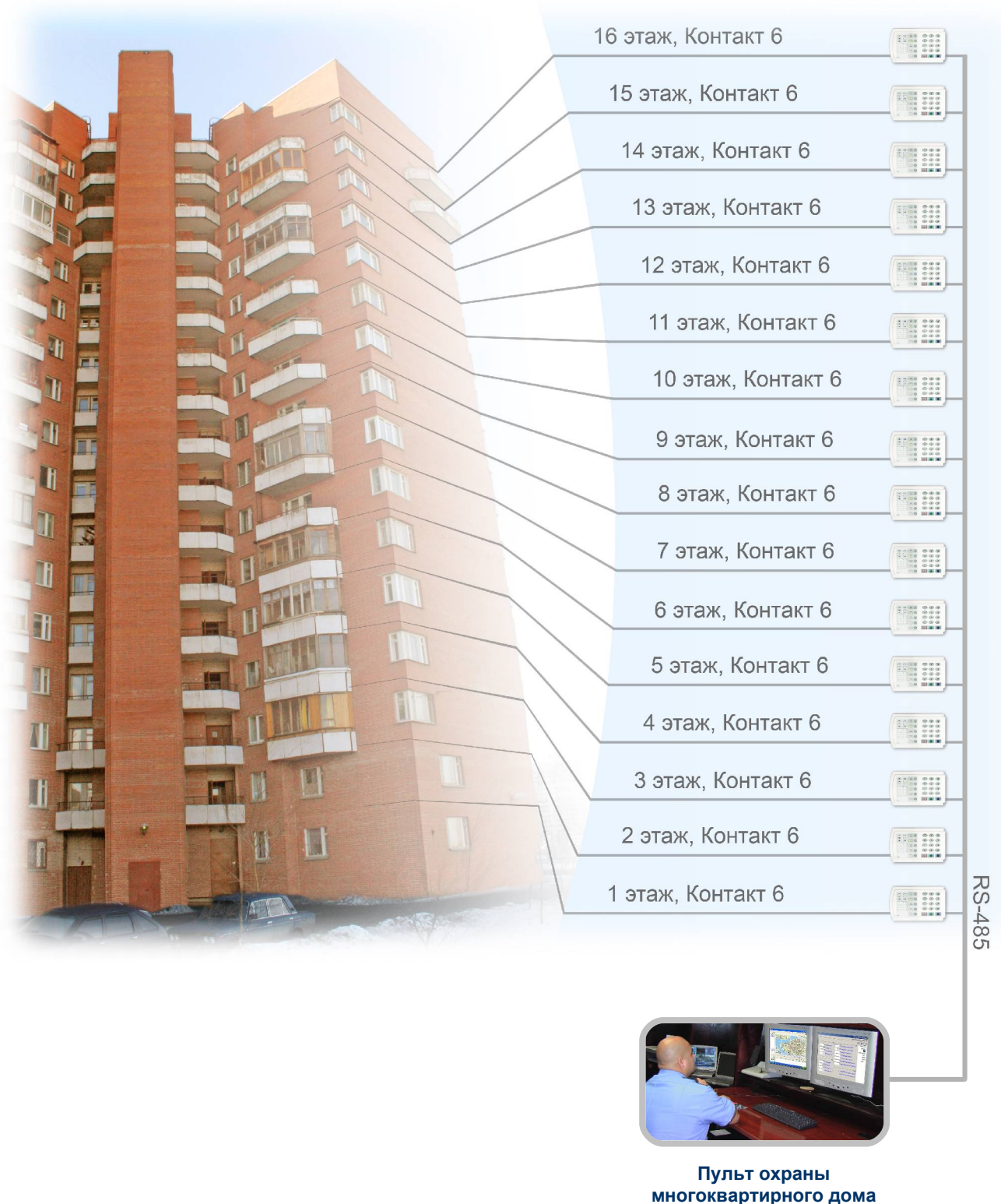
Рис.1.1. Типовое решение №1. Использование «Контактов 6» для охраны многоквартирного дома ТСЖ. Пульт охраны находится в этом же доме.
