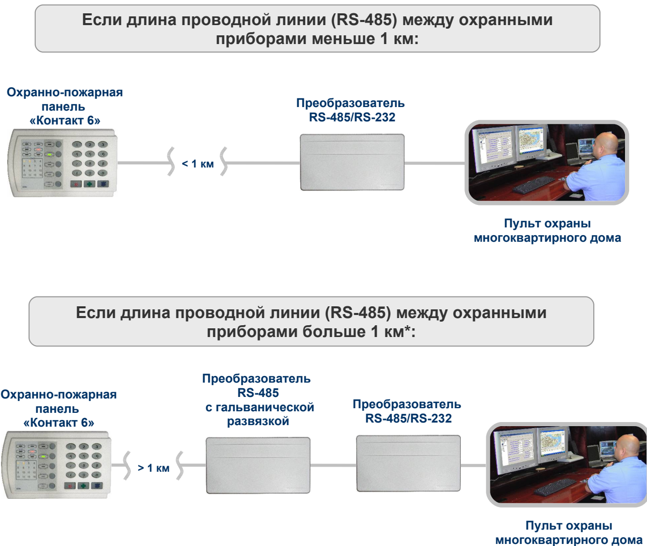
Рис.1.2. Состав приборов для типового решения №1 в зависимости от длины проводной линии (RS-485) между ними.
